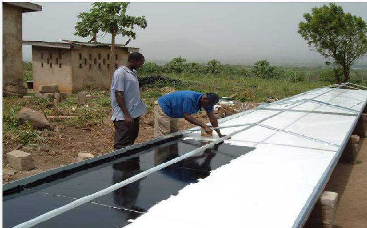
Figure N° 3 : Un séchoir solaire en tunnel au Ghana (SWETMAN, 2007).
