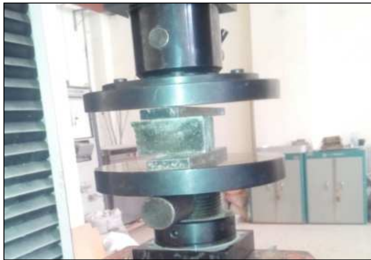
Figure II.2 : Eprouvette avant l'essai de compression.
