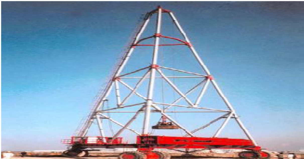
Figure I.3. Pilonneuse de 1600tm.
