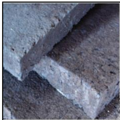
Figure 160 : panneaux de liège expansés ; source : Google image
