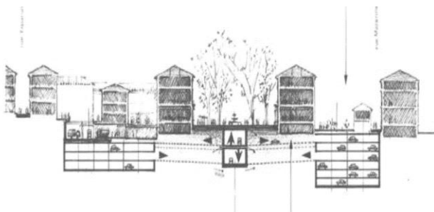
Figure III 10 Parking de 300 places au sous-sol de la place " la Sextienne"
