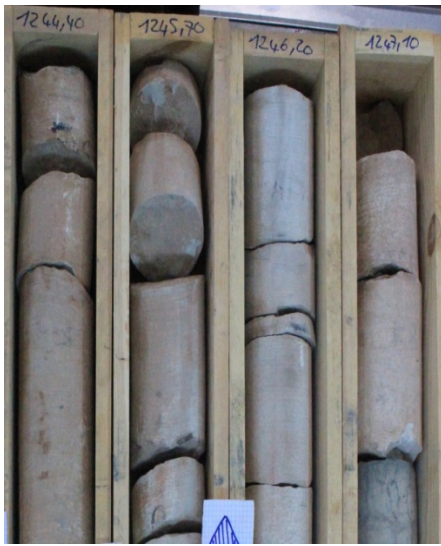
Photo N° 7 : Carotte n°8(1244,82 – 1247,34 m) Faciès gréseux, fin, gris à beige clair, parfois verdâtre.
