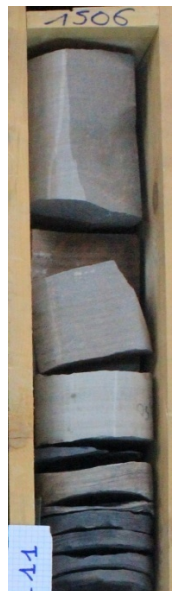
Photo N° 9 : Carotte n°11 (1506,30m) Faciès conglomératique à dominance gréseuse de couleur beige.
