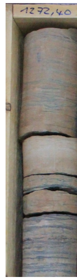
Photo N° 8 : Carotte n°9 (1272,67m) Passage conglomératique à dominance gréseuse.
