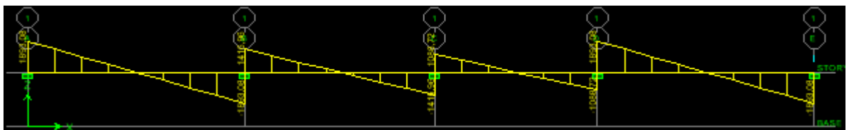
Figure VII.17 : Diagramme des efforts tranchants à l'ELU.
