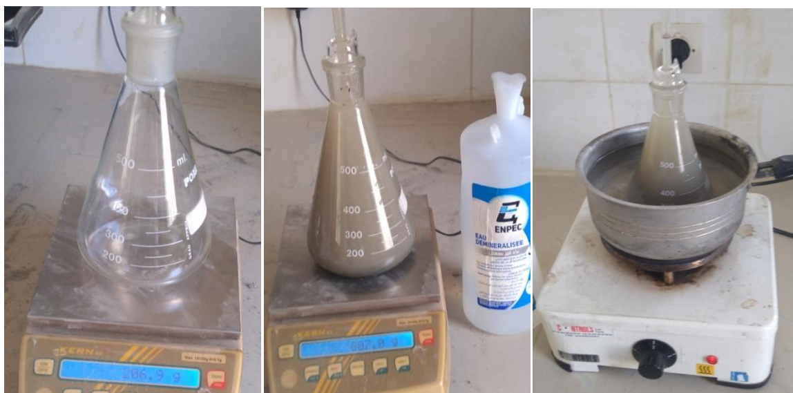
Figure III.5: Exécution de l'essai avec pycnomètre.
