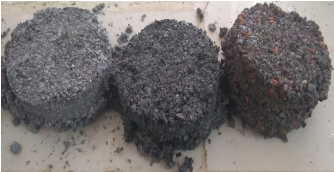
VII Figure VI.9 : Échantillon après cisaillement.
