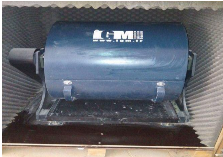
Figure V.4 : Machine d'essai Los Angeles.
