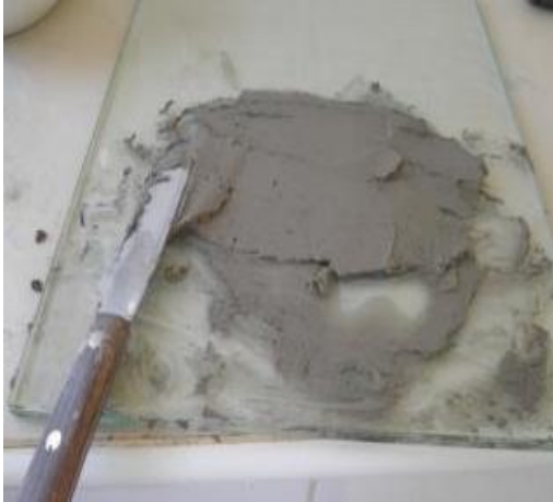
Figure III.7: Détermination de la limite de liquidité.
