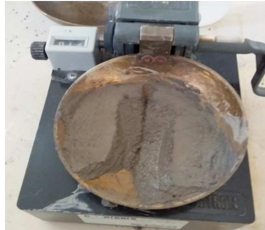
Figure III.7: Détermination de la limite de liquidité.
