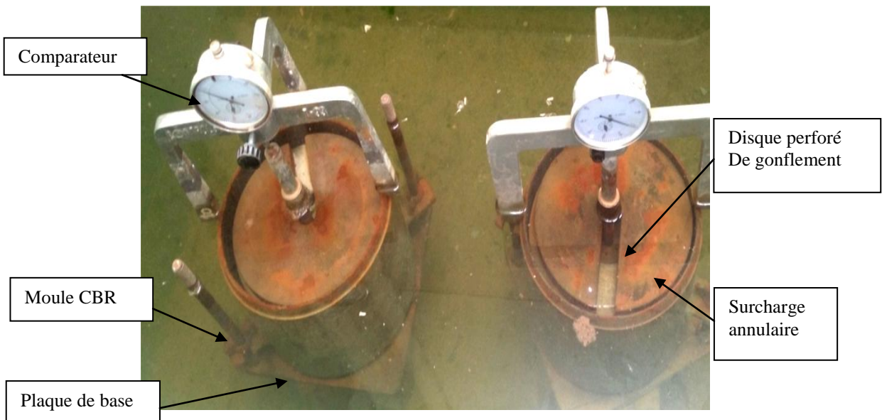
Figure IV.19 : Essai CBR après immersion, imbibition et gonflement.
