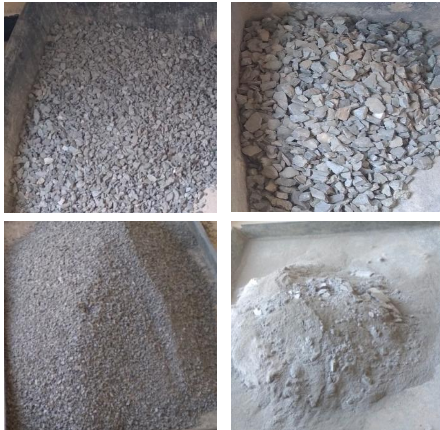
Figure III.2: Granulats du schiste après concassage et tamisage. NFEN13-285(2010).
