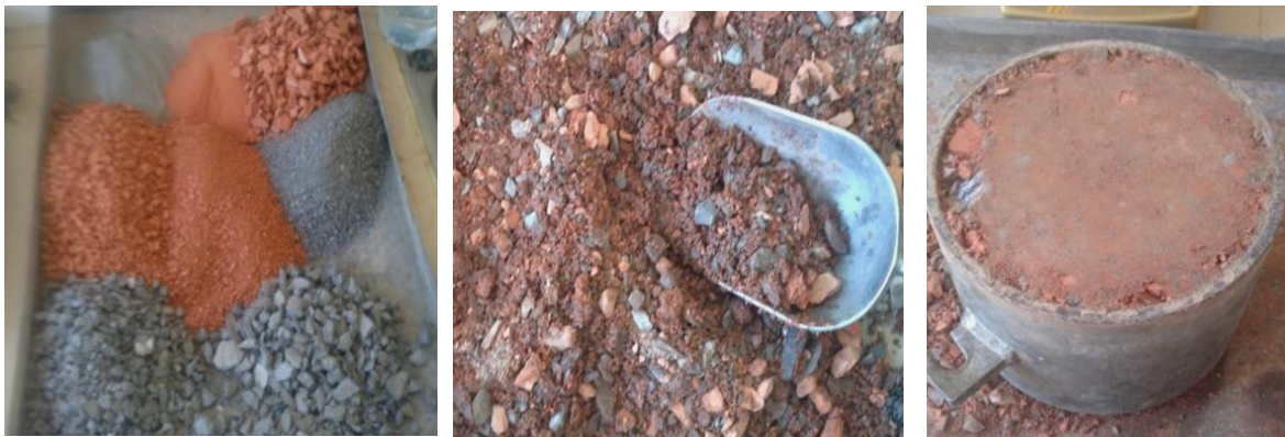
Figure IV.8 : Essai Proctor pour schiste seul
