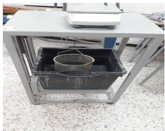
Figure III.4: Mode opératoire. (Pesée hydrostatique.)
