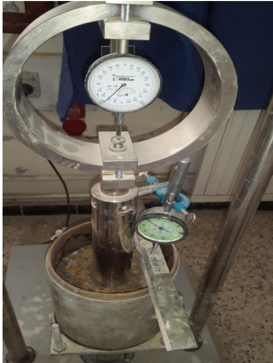
Figure IV.18 : appareil de l'essai CBR (Presse CBR).
