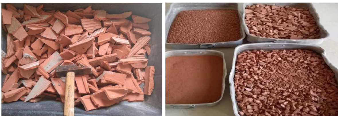
Figure III.11: Débris de brique après concassage et tamisage.
