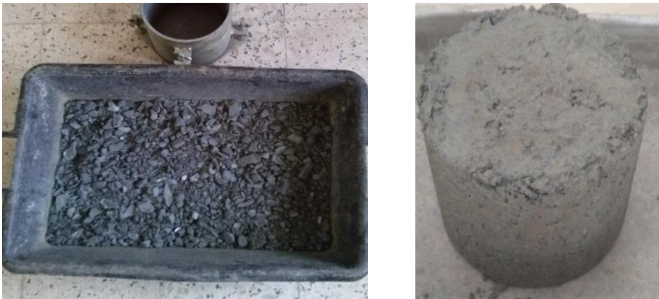
Figure IV.8 : Essai Proctor pour schiste seul
