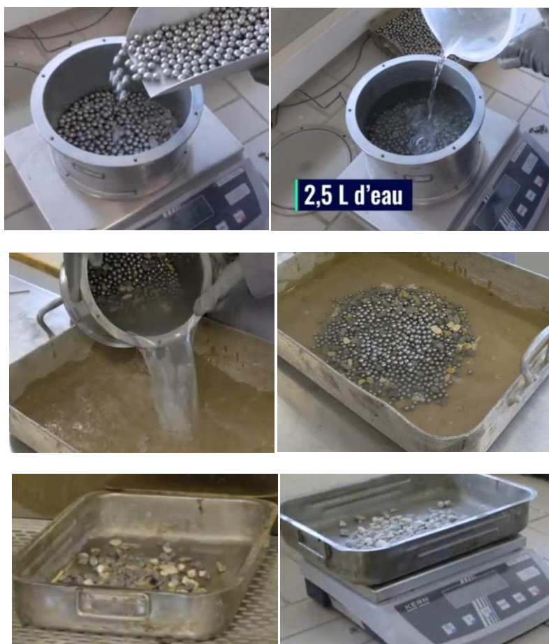
Figure V.2: Mode opératoire d'essai micro Deval.
