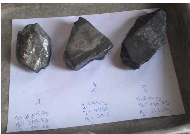
Figure III.4: Mode opératoire. (Pesée hydrostatique.)
