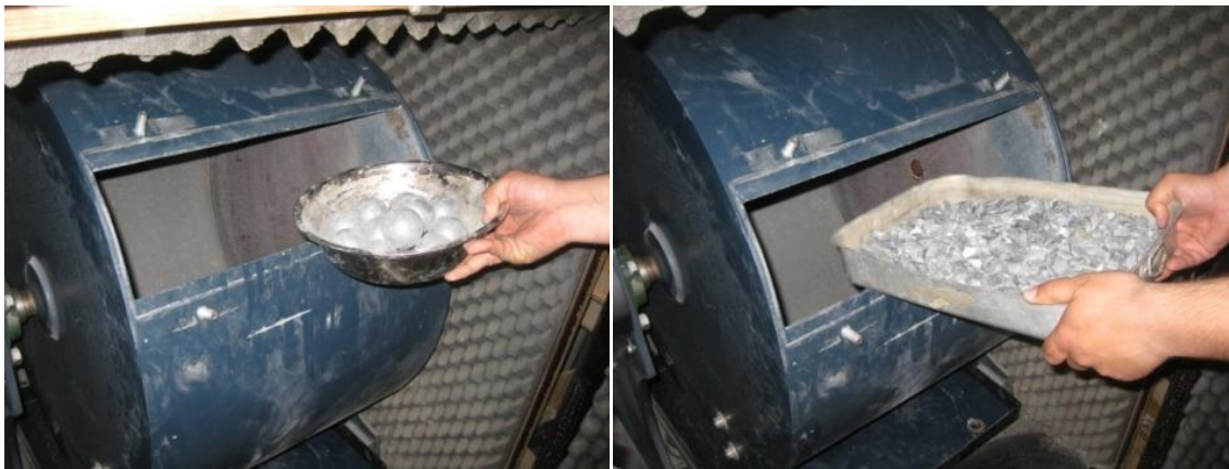
Figure V.5 : Mise en place des granulats pour l'essai Los Angeles.
