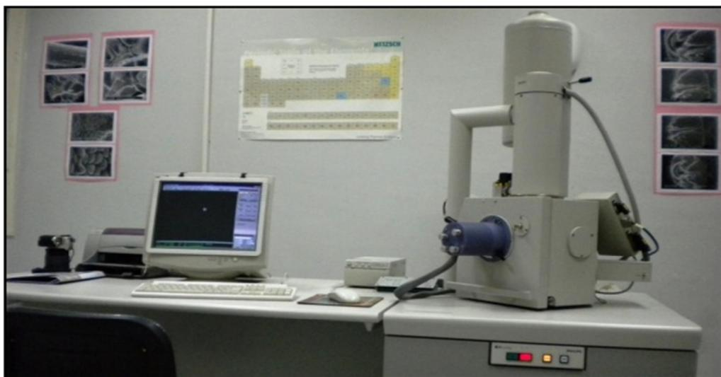
Figure 03: MEB ESEM XL 30 Philips à filament de tungstène (Originale, 2016)
