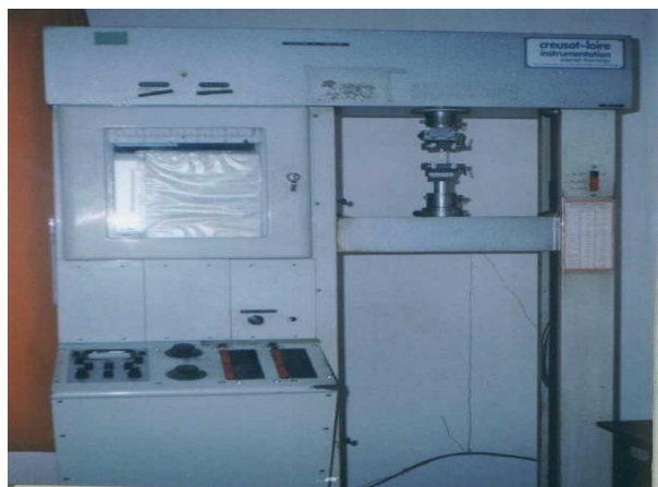
Fig.V.2. Machine à traction pour essais mécaniques.
