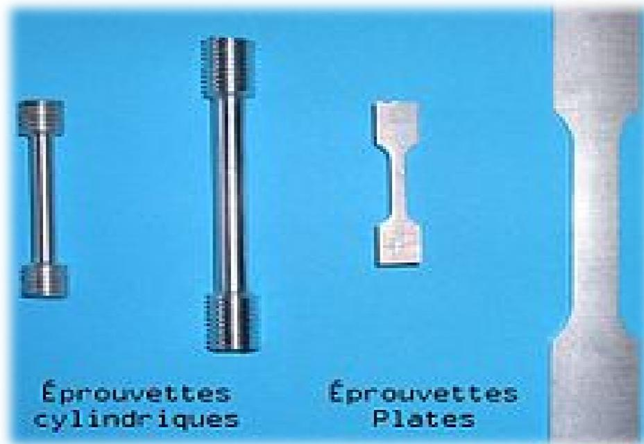
*Figure V.1 : les éprouvettes de traction.*
