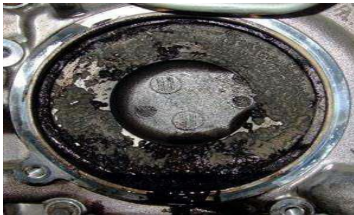
Figure I-5: Couvercle de pompe à eau érodé par la cavitation
