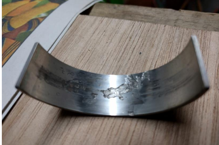
Figure I-4 : Coussinet de bielle érodé par la cavitation
