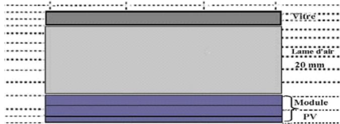
Configuration 2 : capteur solaire PV vitré et isolé thermiquement
