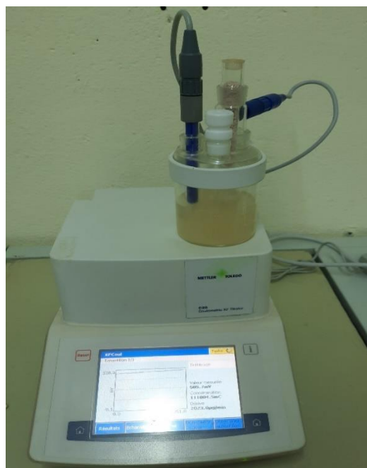
Figure III.3 : Dispositif d'essai de la teneur en eau
