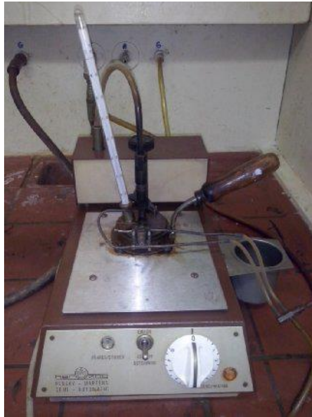
Figure III.7 : Testeur de point d'éclair
