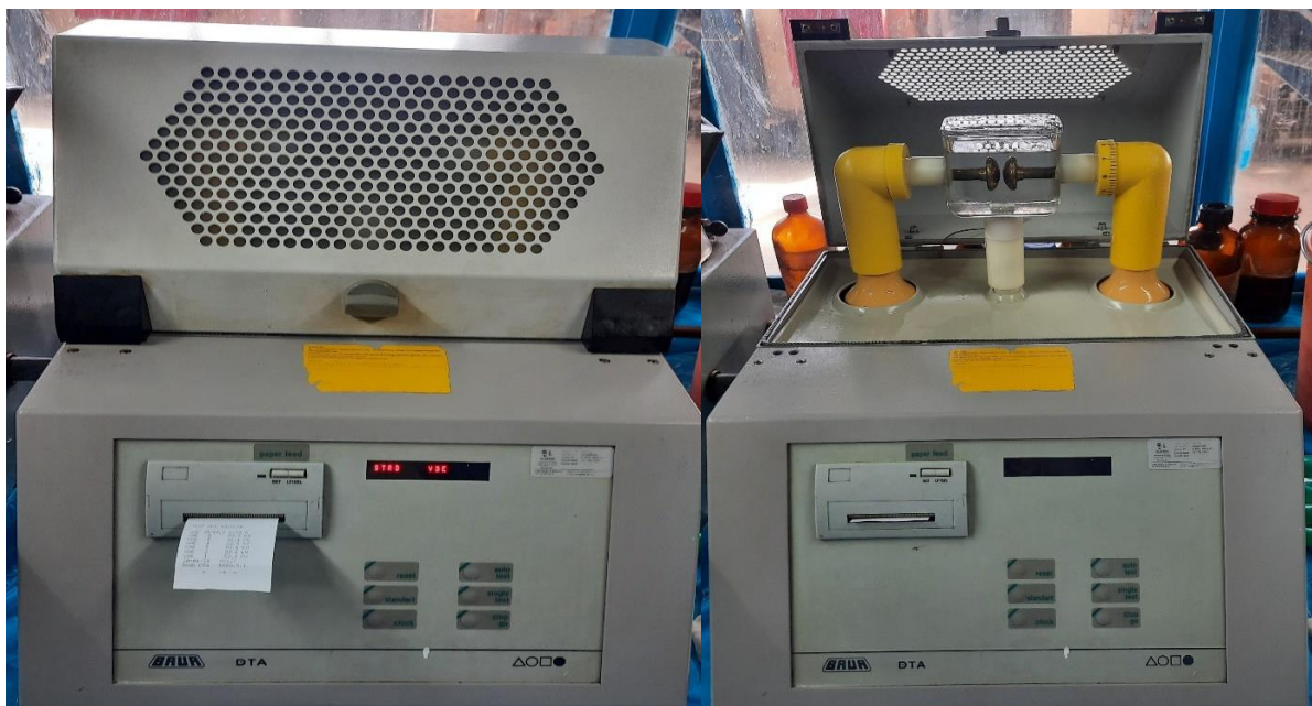
Figure III.1 : Dispositif d'essai de la tension de claquage
