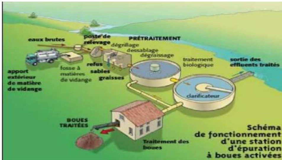
**Figure n°01 :** Schéma de fonctionnement d'une Station d'épuration à boue activée. (ADME,2000).
