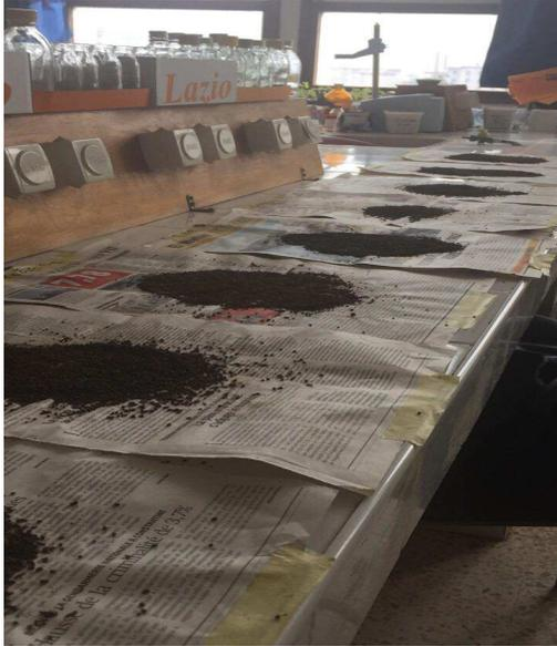
**Figure n° 21:** séchage du sol.
