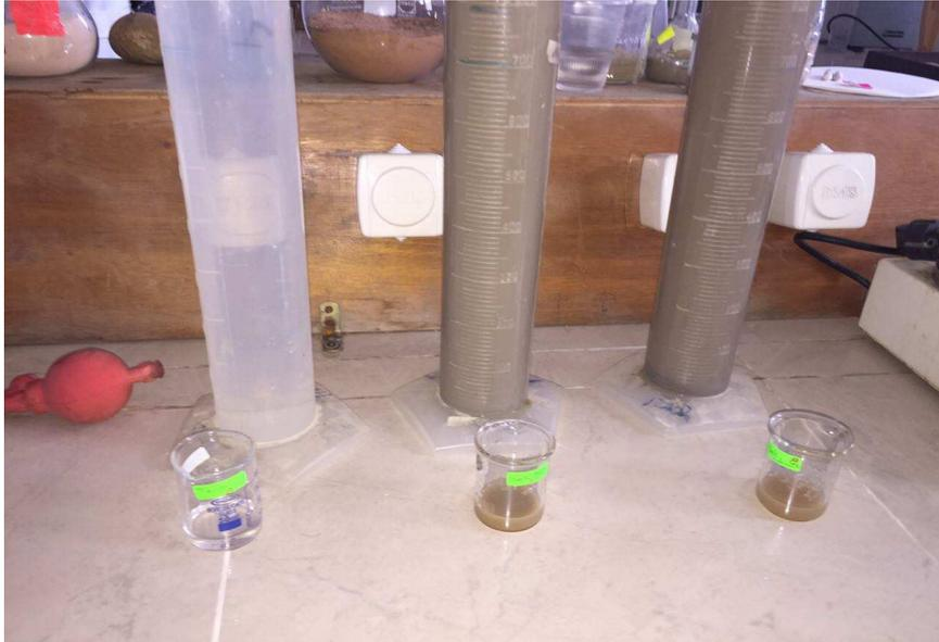
**Figure n°23 :** Analyse de la granulométrie.
