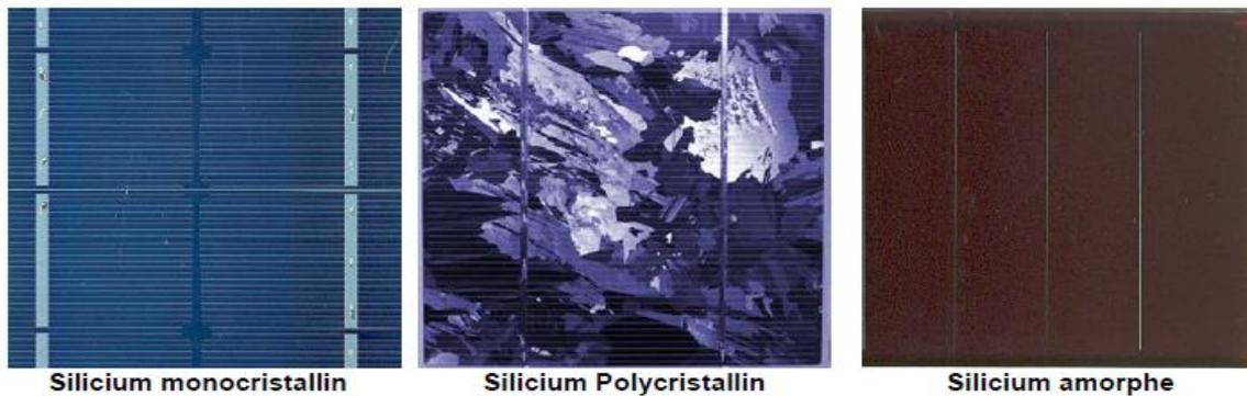
**Figure 2.6 : Technologies utilisées**
