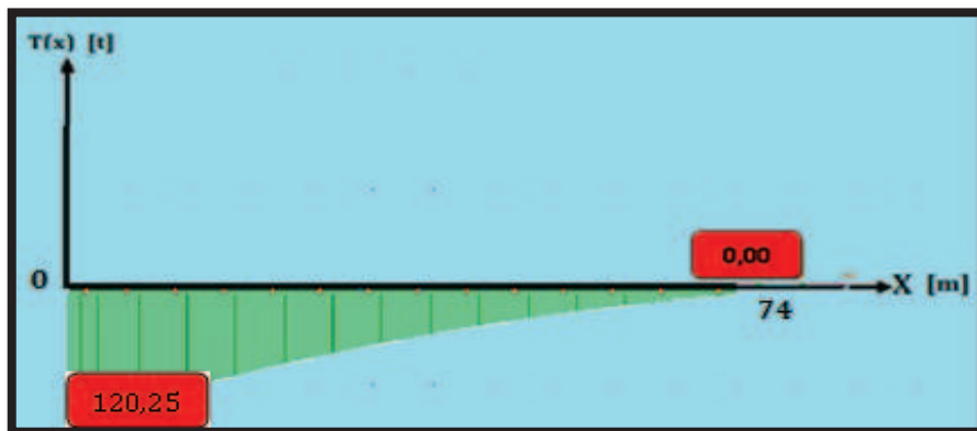
Figure VII.38 : Diagramme des efforts tranchants de demi-fléau de 74m sous Q_w .
