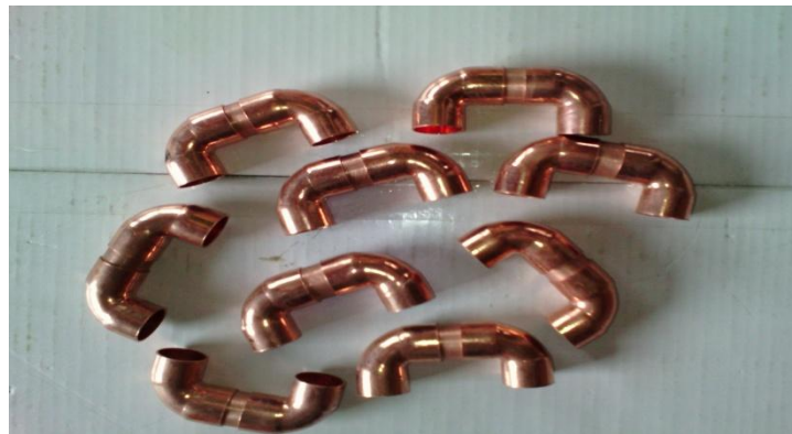
Figure IV.8 : Assemblage des coudes avec les petits tubes.
