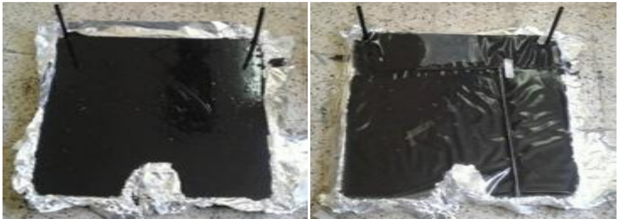
Figure IV.12 : Le conteneur rempli avec le composite.
