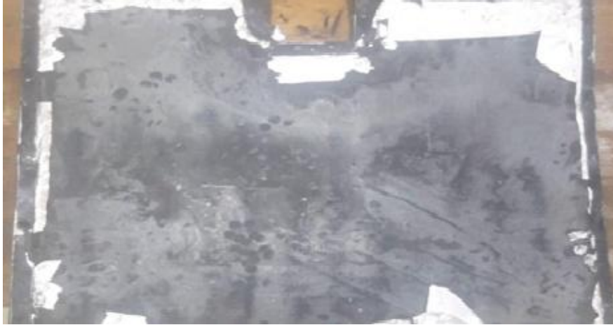
Figure IV.16 : Le composite après solidification.
