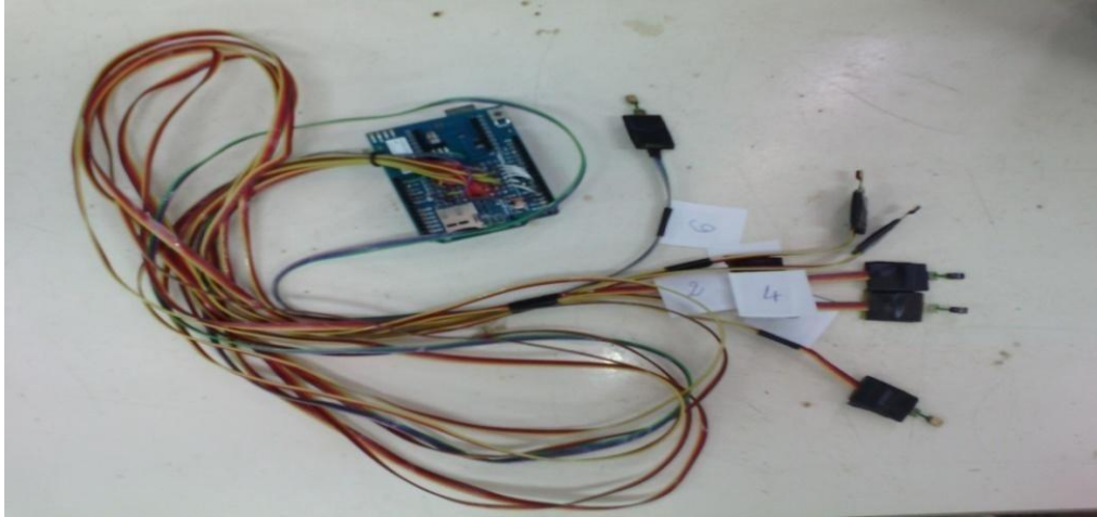
Figure IV.15 : Les capteurs de températures utilisés.
