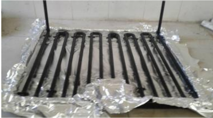
Figure IV.11 : L'échangeur à l'intérieur du conteneur.
