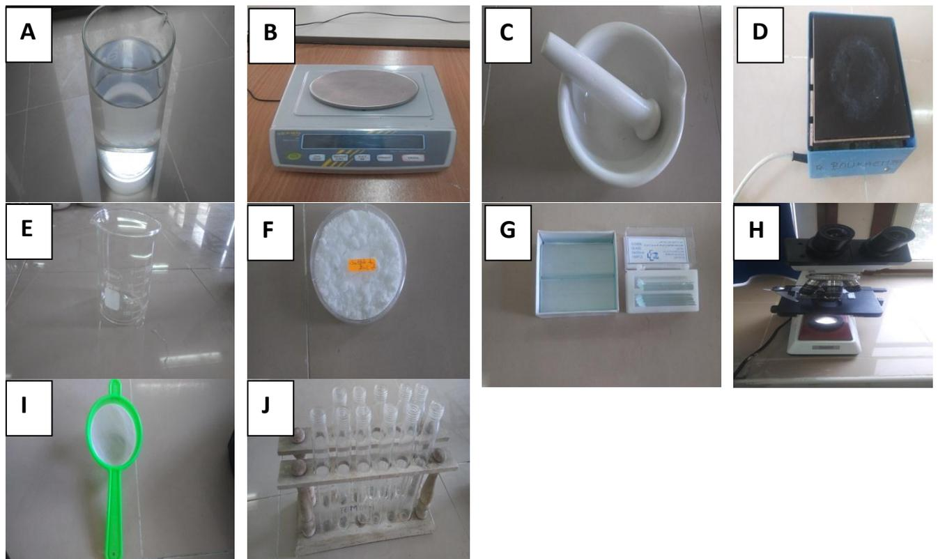
**Figure 11 :** A)Solution salée.B)Balance.C)Mortier.D)Plaque chauffante.E)Becher gradué.
