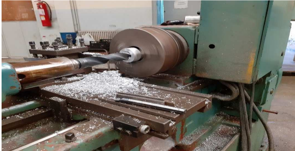
Figure.4.12. Image de perçage avec le tour mécanique.
