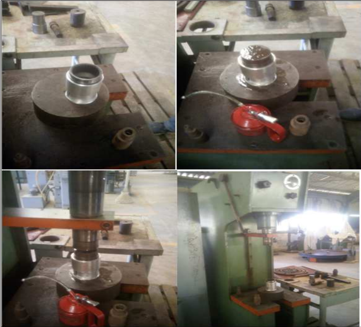
Figure.4.17. Montage de roulement dans la turbine avec la presse.
