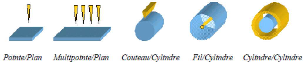
Figure I.4 : Systèmes d'électrodes couramment utilisés pour générer la décharge couronne [7].
