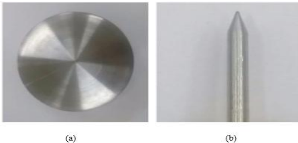
Figure III.3 : Photos des électrodes utilisées :(a) électrode plane, (b) électrode pointue
