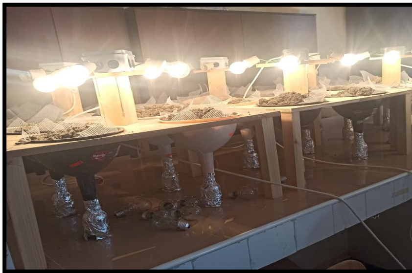
Figure 9 : Appareil de Berlèse modifié (Originale, 2021).
