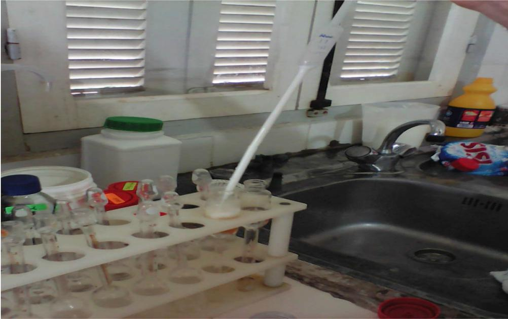
**Figure 6 : Dosage de la matière grasse par la méthode Gerber (acido-butyrométrie)**
