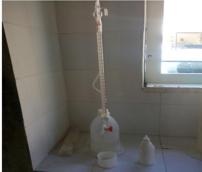
**Figure 4 : Vue de l'acidimètre utilisé au niveau du laboratoire de l'unité**
