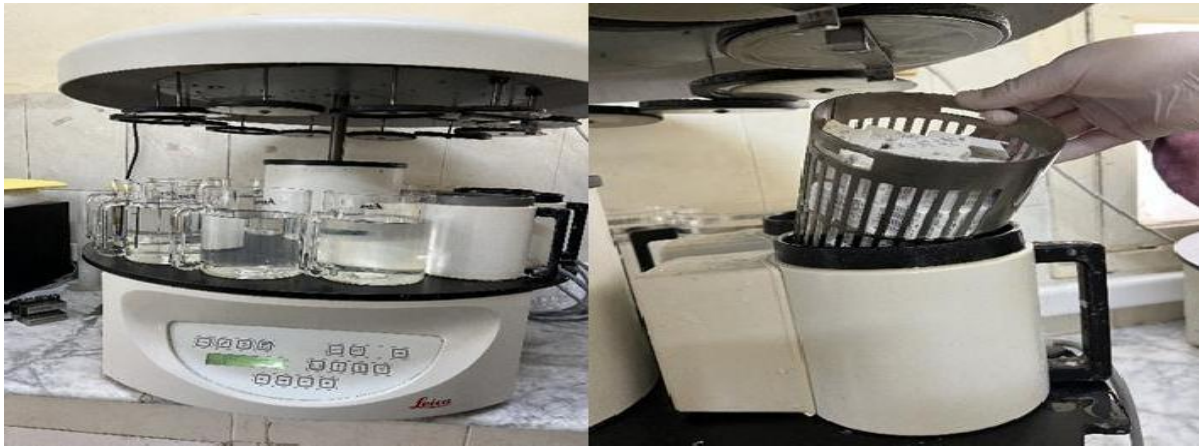
Figure 16 : Automate de déshydratation et d'inclusion de type Leica du laboratoire d'anatomo-pathologie de CHU de Tizi-Ouzou.
