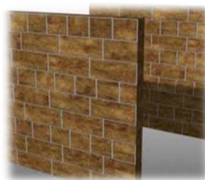
Figure 173: cloison de brique.
