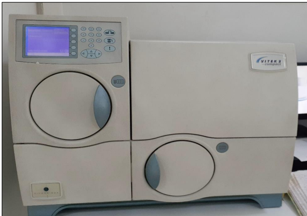
Figure 8 : L'automate VITEK® 2 compact
