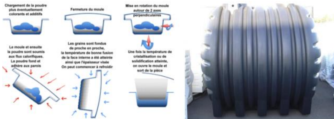
Figure II.21 : Le procédé Rotomoulage.
