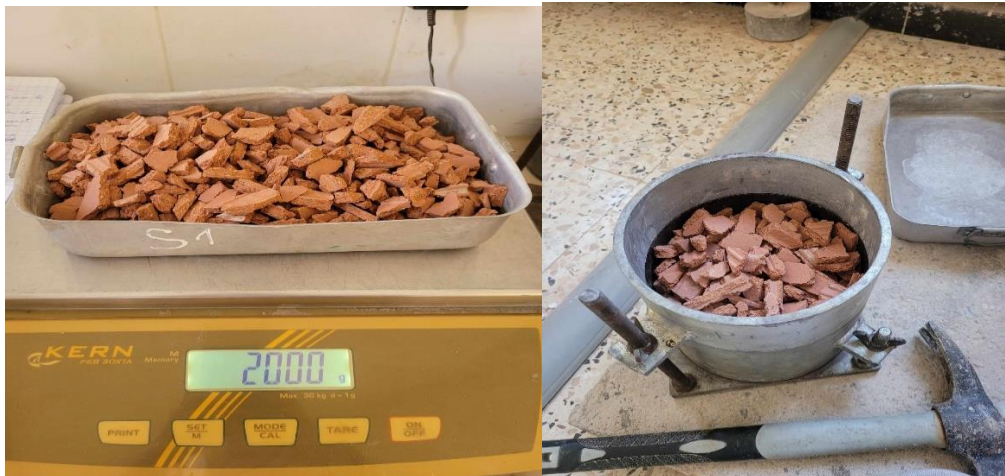
Figure V.14. Pesée et mise du matériau dans le moule CBR
