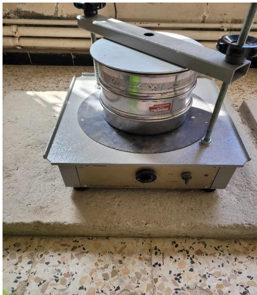
Figure III.4. Tamisage électrique (Dans les cas des petits grains)
