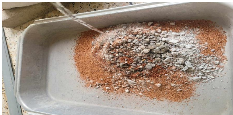
Figure IV.8. Préparation du mélange débris de béton et débris de brique
