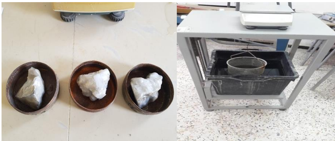
III.6. Mode opératoire de l'essai par pesée hydrostatique
