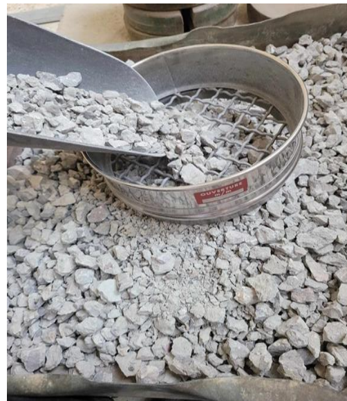
Figure III.5. Tamisage du béton à la main (Dans les cas des gros grains)
