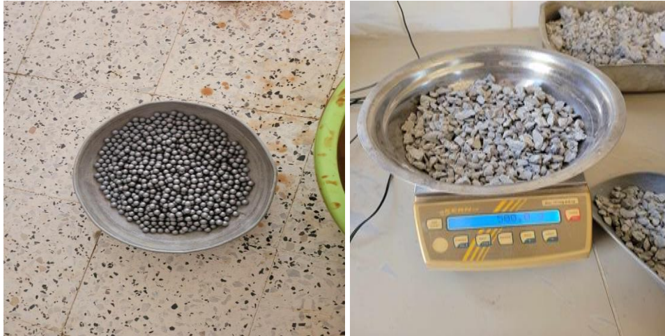
Figure V.2. La charge abrasive et le matériau pesé
