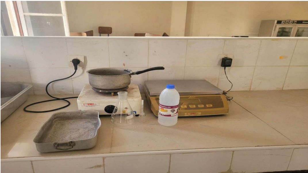
Figure III.7. Exécution de l'essai au pycnomètre
