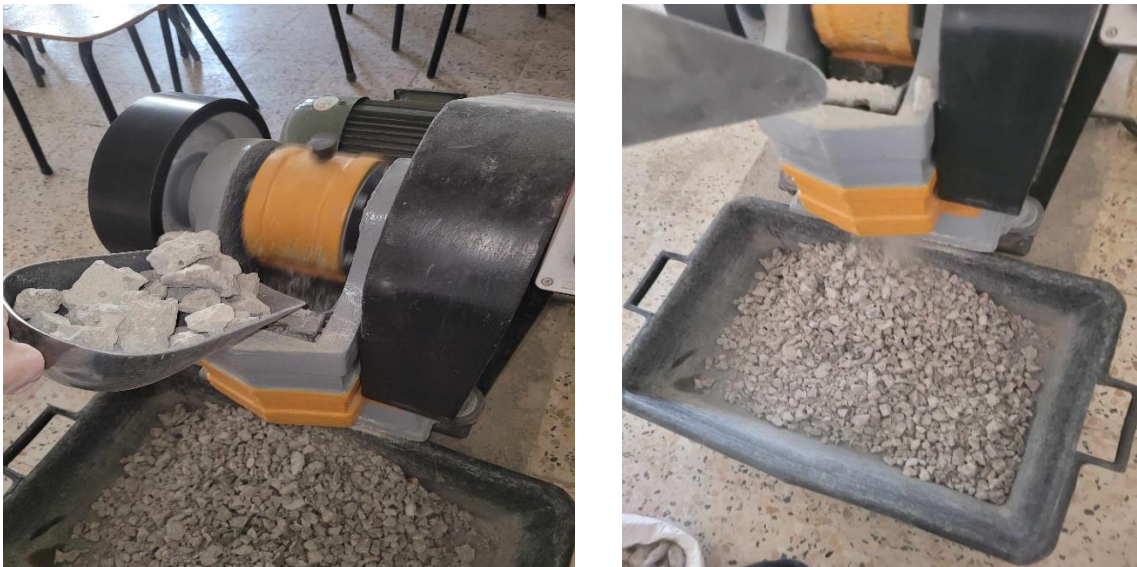
Figure III.2. Concassage du béton
