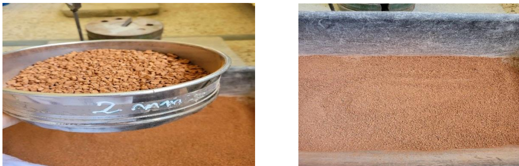
Figure III.8. Concassage et tamisage des débris de brique.
