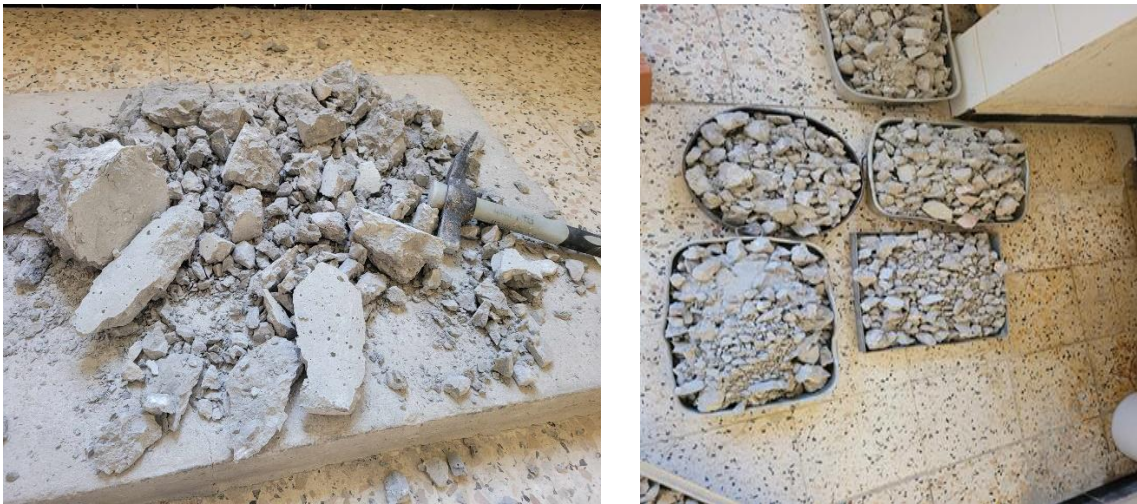
Figure III.1. Le béton brisé manuellement
