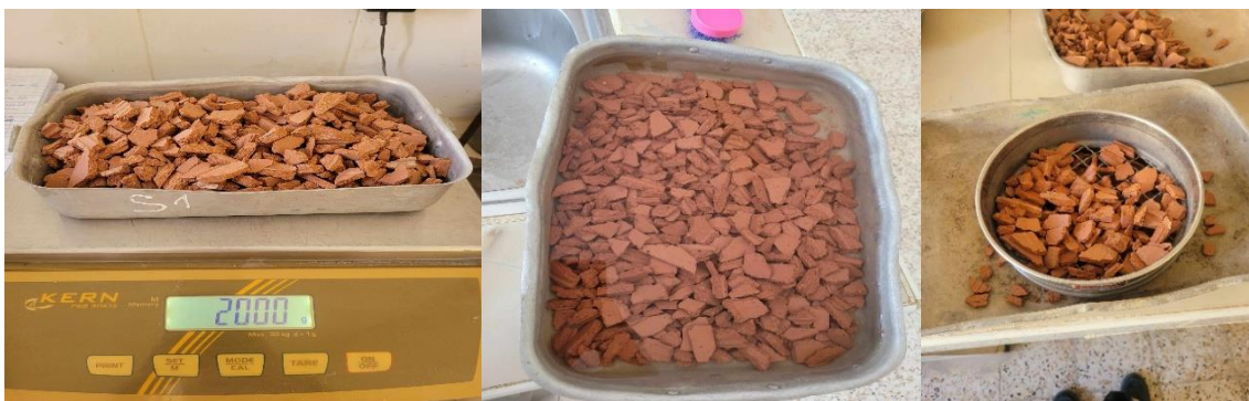
Figure V.9. Pesée et immersion et tamisage du matériau.
