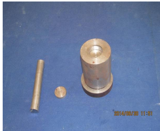
Figure VI.3 : Moule métallique conçu pour l'élaboration du composite.
