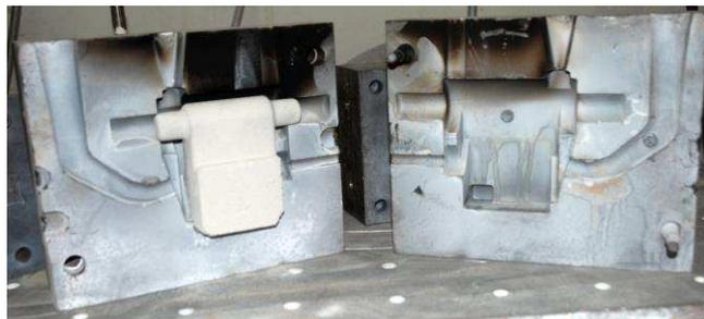
*Figure 9 : Moule en coquille avec noyau positionné .*
