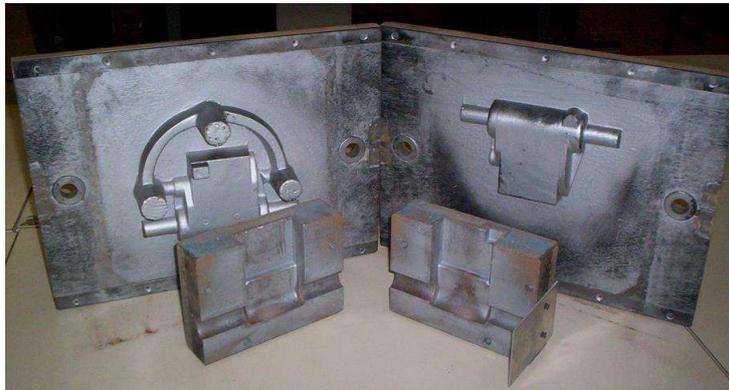
*Figure 8 :Plaque modèle métallique pour moulage en sable .*
