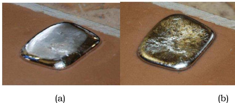
*Figure 13 : Haut de la coulée (a) immédiatement après la coulée, aluminium encore liquide (b) après quelques minutes de refroidissement, formation de la retassure externe .*
