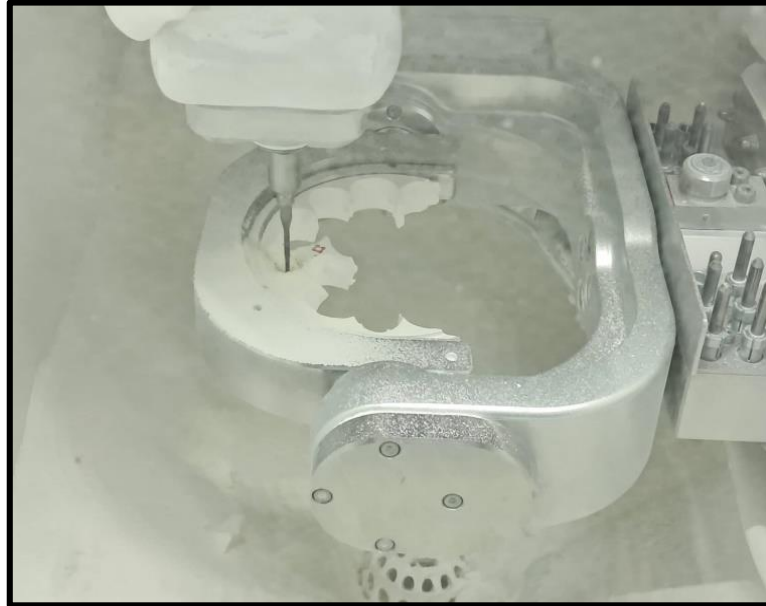
Figure IV.63: La sculpture de la couronne dans le disque En zircone avec la fraiseuse.
