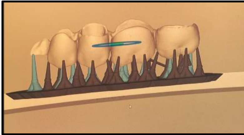
Figure IV.25: Visualisation du bridge avec supports dans Raydent.
