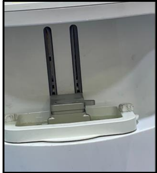
Figure IV.28: Descente du bras dans la cuve à résine lors de l'impression.
