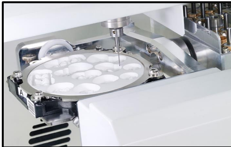
Figure III.15: Machine d'usinage pour prothèse dentaire [14].
