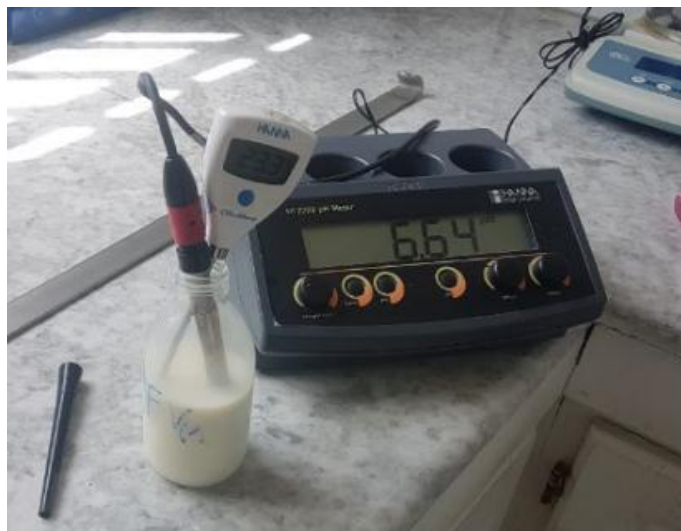
Figure n°19 : Détermination du pH à l'aide d'un pH mètre au niveau de laboratoire de Tifra lait.
