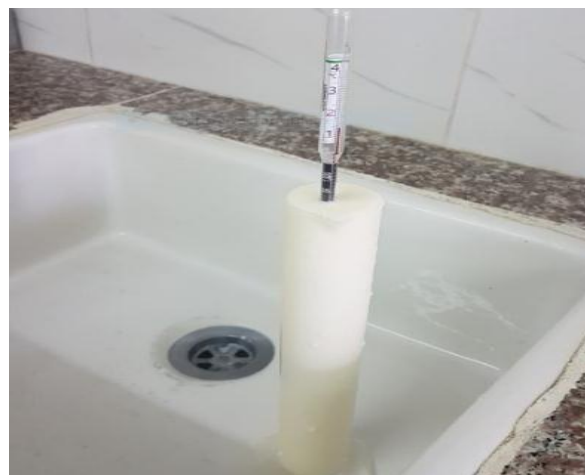
Figure n°21 : Un lacto densimètre plongé dans une éprouvette du lait cru.
