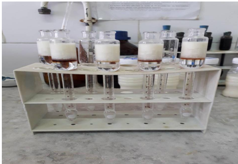
Figure n°23 : Analyse de lait par la méthode acidobutyrométrique.
