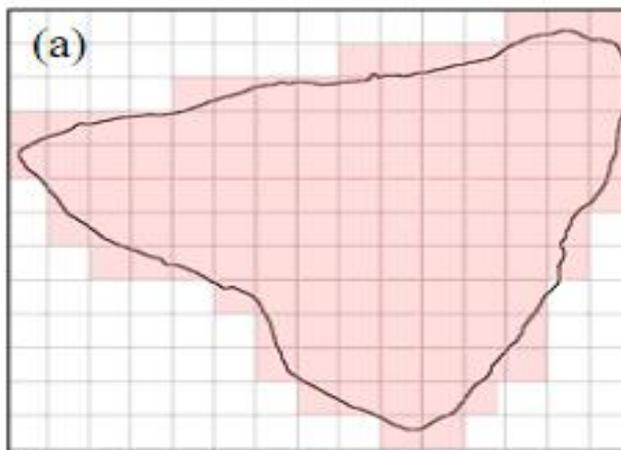
Figure II-6 :(a) application de la dimension fractale de fragmentation par Box Counting
