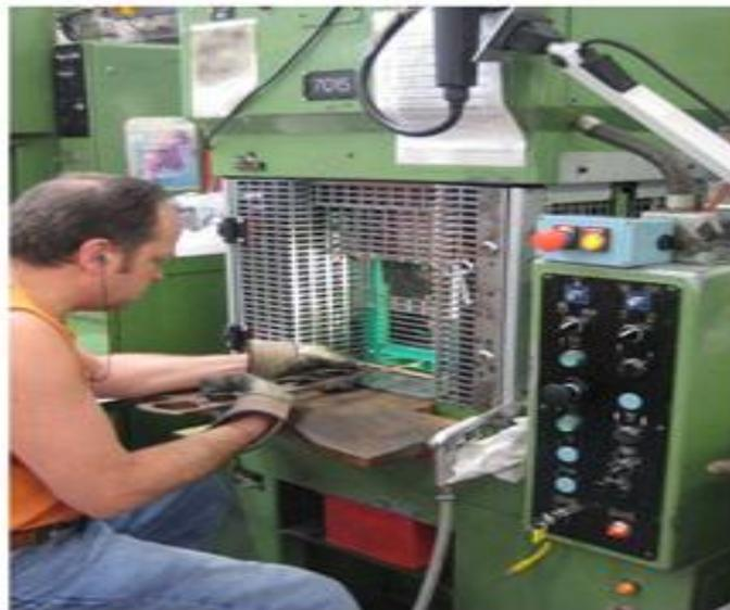
**Figure 28 : presse avec un isolons de la zone dangereuse**
