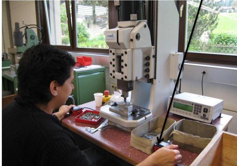
**Figure 27 : presse à protection bi manuelle**
