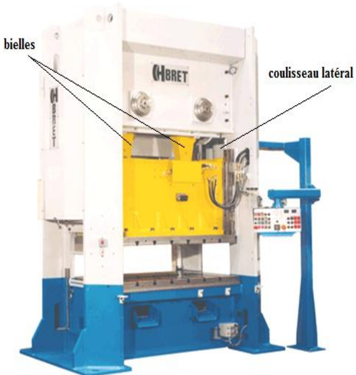
**Figure 11 : presse mécanique a monobloc [HBRET]**
