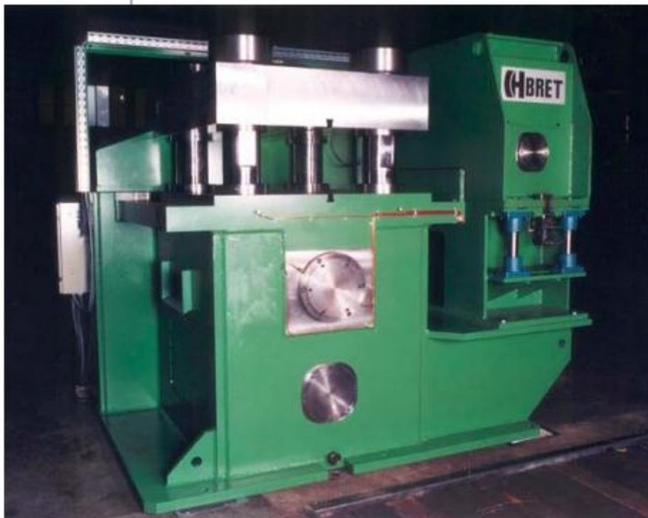
**Figure 22 : presses hydrauliques à quatre colonnes [HBRET]**
