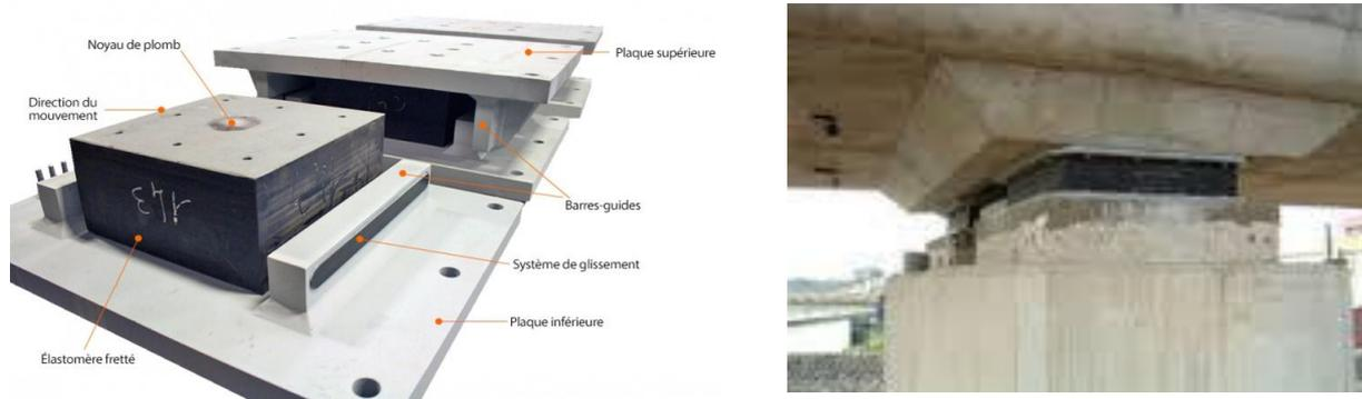
Fig. X.1 : Appareil d'appui en élastomère fretté.
