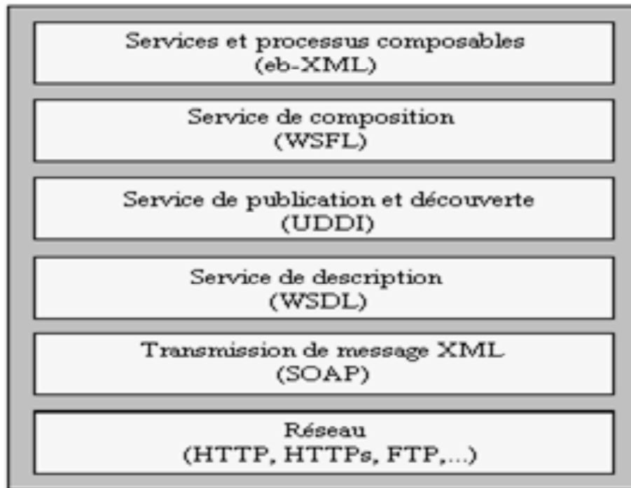
Figure I-9: Architecture en couches des protocoles et standards des services Web [KRC 01]
