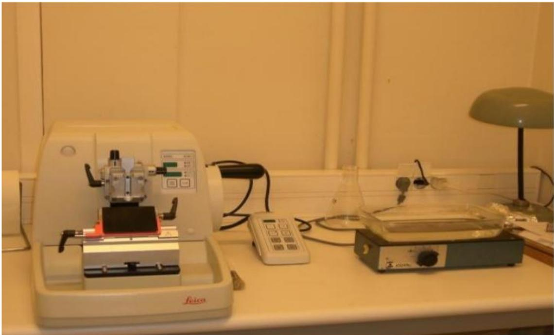
**Figure 18:** Dispositif permettant de faire des coupes : microtome à gauche et bain Marie à droite.
