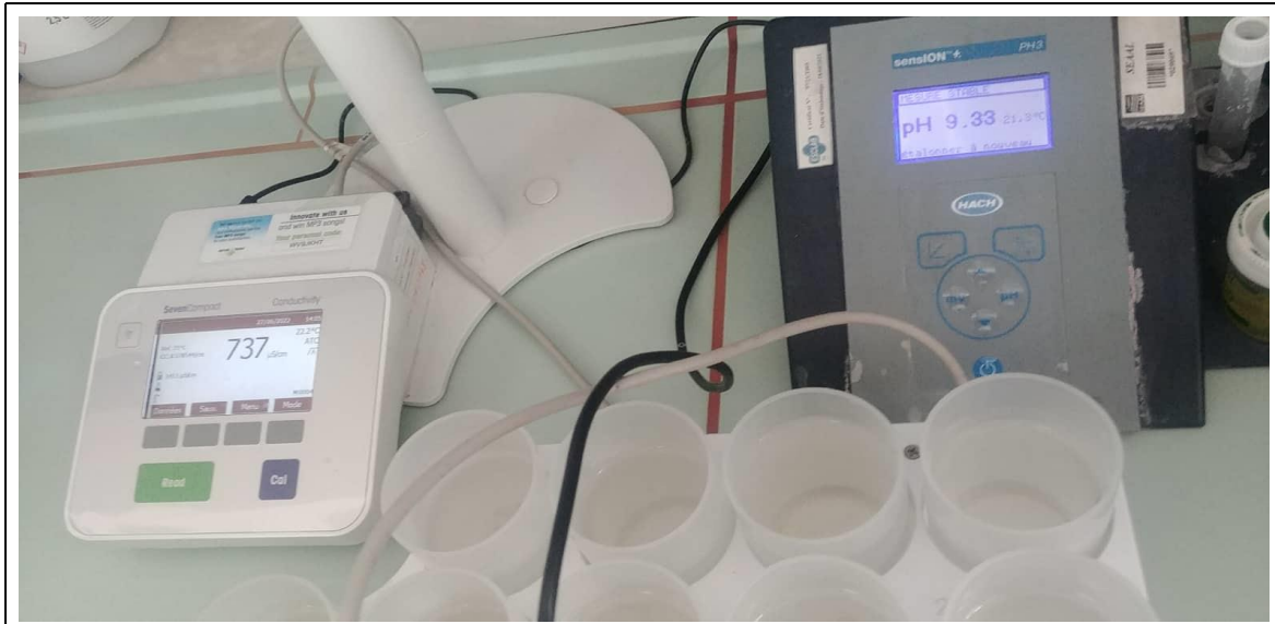
Figure IV.13: Mesure de pH, et T°C au pH-mètre et conductivité au conductimètre
