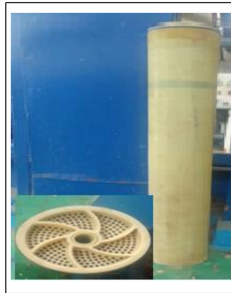
Figure IV.10: Module d'osmose inverse
