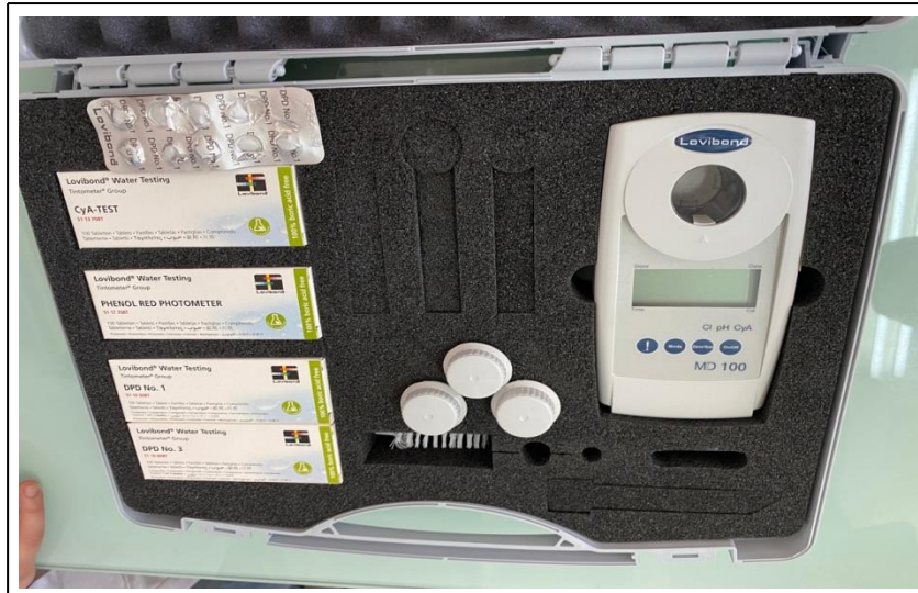
Figure IV.20 : Automate de mesure de chlore
