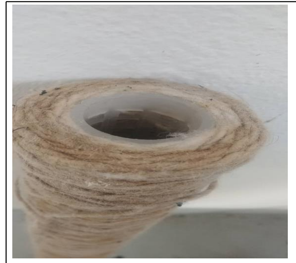
Figure IV.8 : Micro filtre de 5 \mu\text{m}
