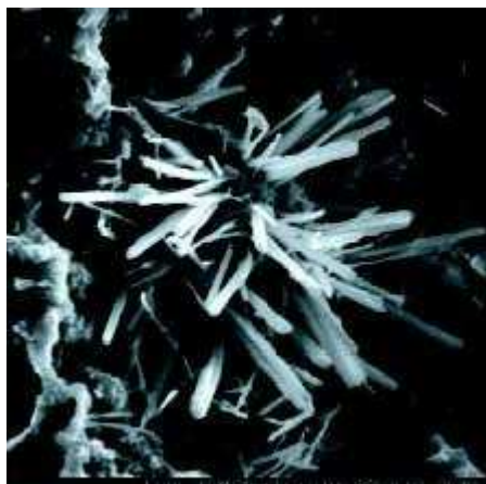
Figure 2.5: Ettringite primaire non expansive dans la pâte de ciment, vue au microscope électronique à balayage.
