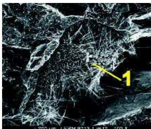
Figure 2.6 : Ettringite secondaire non expansive dans un pore (1), vue au microscope électronique à balayage.
