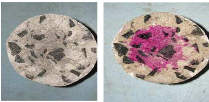
Figure 2.3: Détermination de la profondeur de carbonatation [28].
