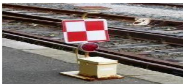
Figure X-3 : signal d'arrêt à main
