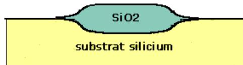
**FIG I.27** Effet d'une oxydation localisée du Silicium. L'augmentation de volume crée un relief à la surface de la plaquette.
