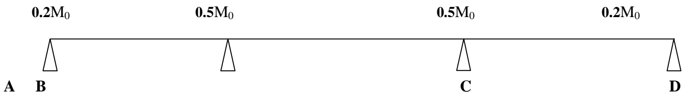
Fig. : III-2-6) correction des moments sur appuis
