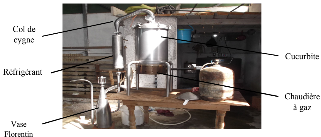
Figure 2.2 : Photo du montage à extraction par hydrodistillation.
