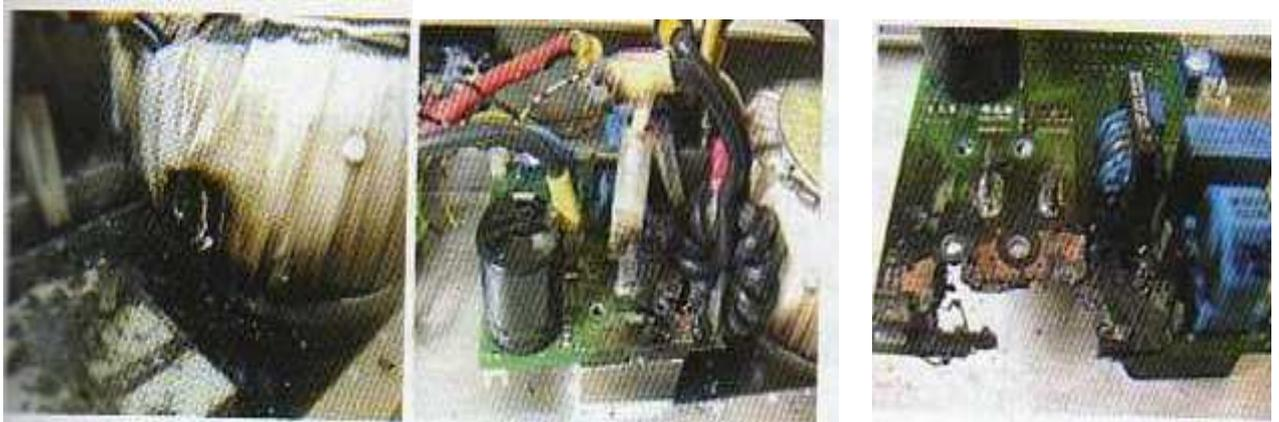
Fig. IV.4: Surtension dans un onduleur [15]
