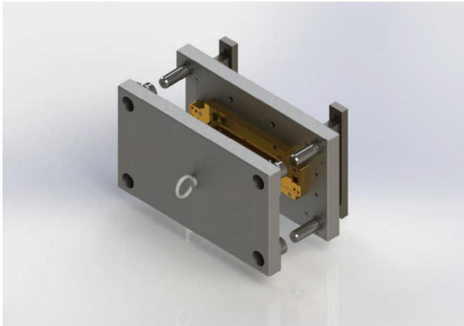
Figure IV-2 Moule à emboutissage
