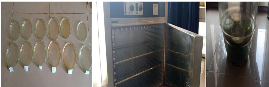
Figure 7: Echantillons préparés pour l'analyse de l'humidité (étuve et dessiccateur)
