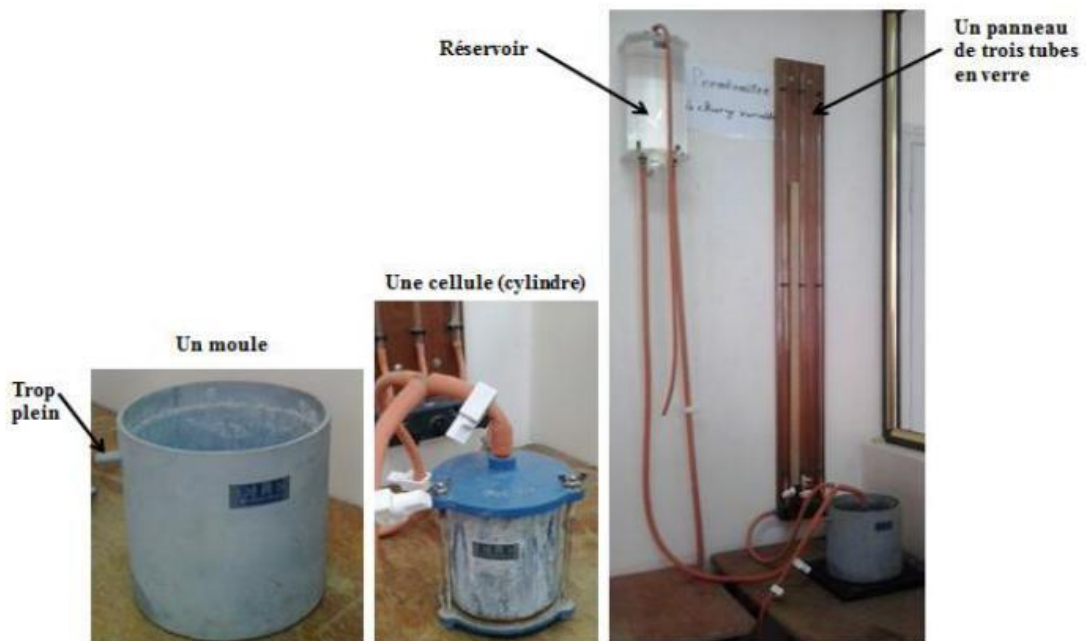
Figure II.7 : perméamètre à charge variable
