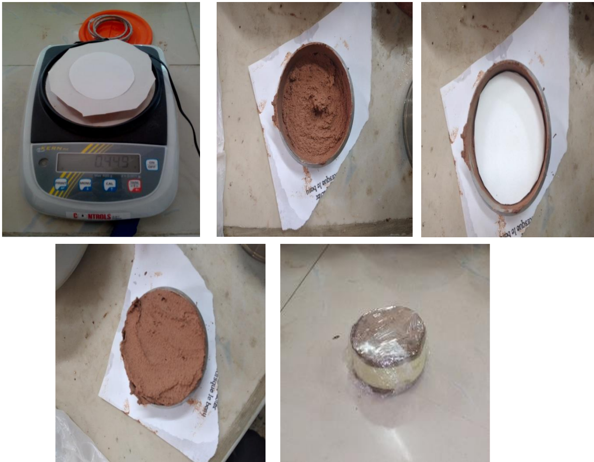
Figure IV.4 : Protocole de mesure de la succion matricielle au papier filtre Wathman N°42.
