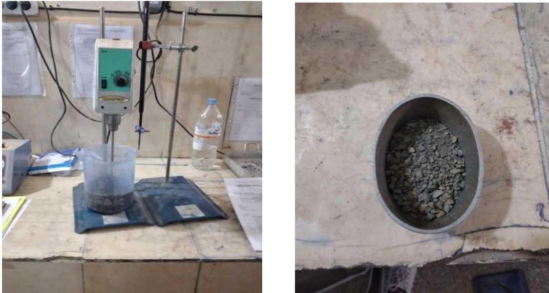
Figure III.23 : Matériel d'essai au bleu de méthylène + échantillon.
