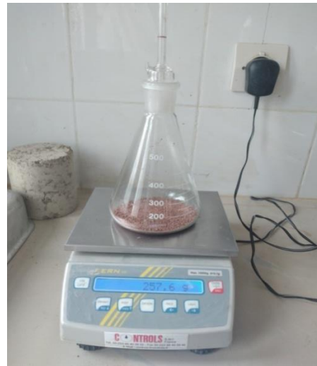
Fig. III.20 : Pesée (pycnomètre + matériau)
