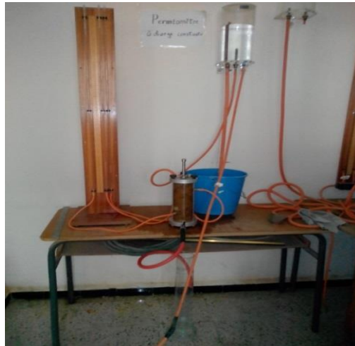
Figure II.5 : perméamètre à charge constant.
