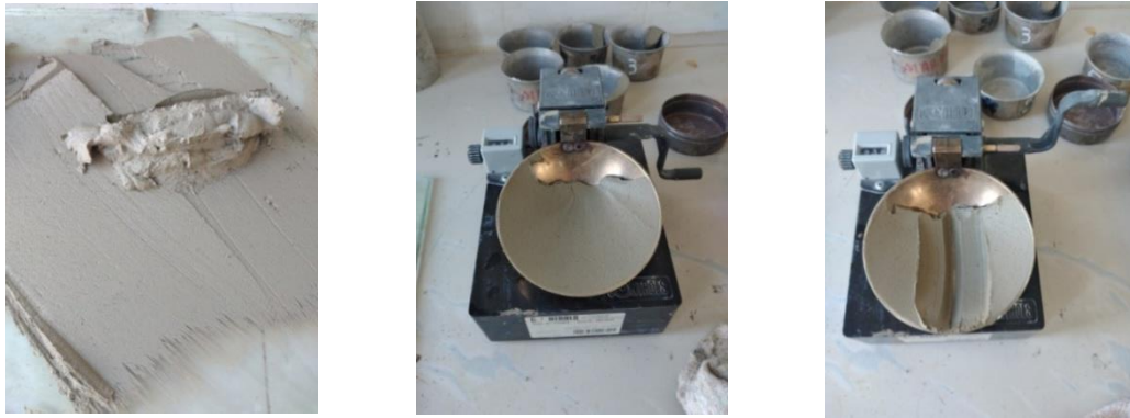
Figure III.13: Détermination de la limite de liquidité
