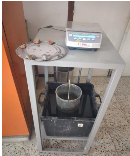
Figure III.22 : Principe et matériels de la pesée hydrostatique.
