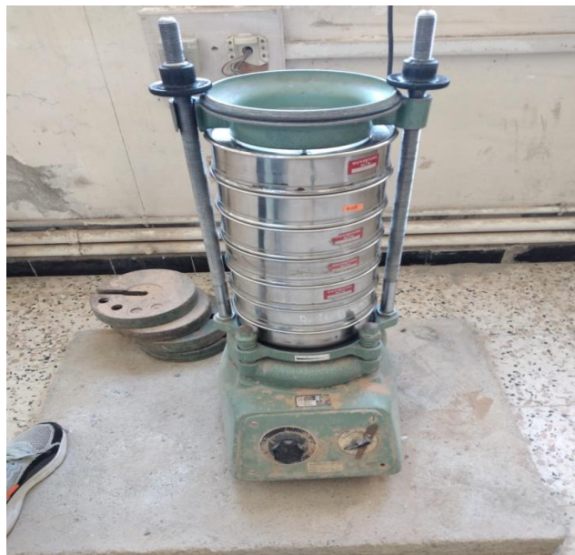
Figure III .8 : Analyse granulométrique par tamisage.
