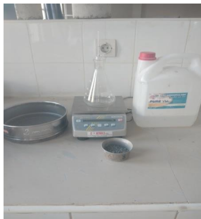
Figure III.18 : Equipement de l'essai (pycnomètre).
