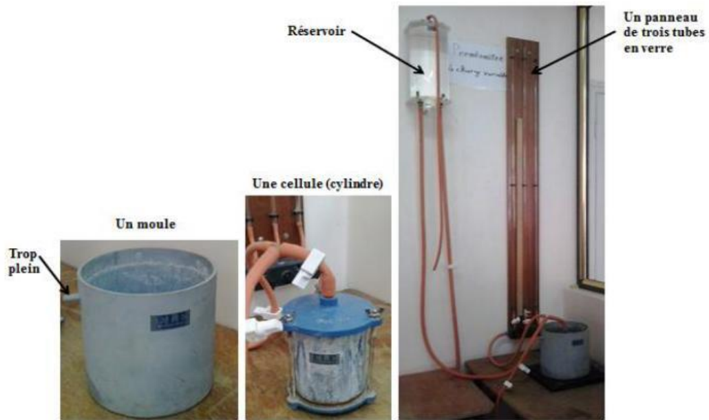
Figure IV. 2 : Perméamètre à charge variable.
