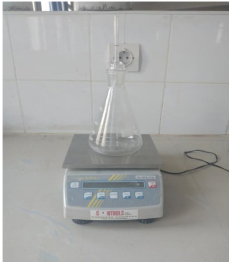
Fig. III.19: Pesée du pycnomètre à vide
