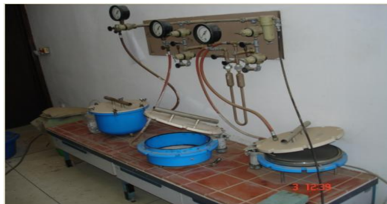
Figure I.15 : Appareil de Richards
