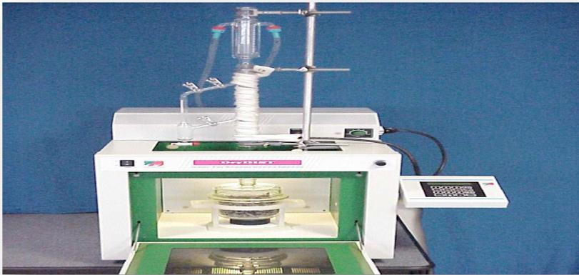
**Figure 4 :** Technique d'extraction par micro-onde (CHEMAT, 2011).
