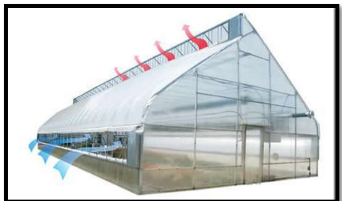
Figure 78 : schéma représentatif de la ventilation d'une serre Source : info@sahgh.com
