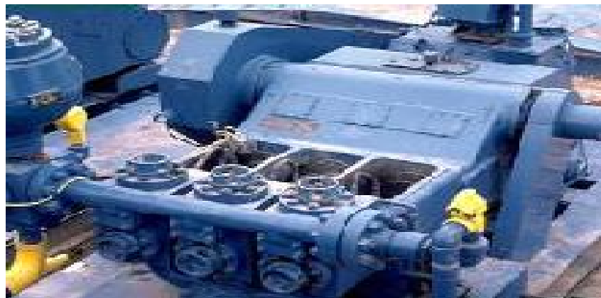
Figure (I.8) : Pompe triplex à simple effet [1]
