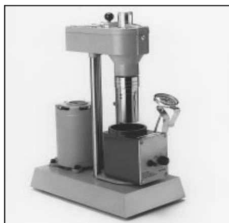
Fig. II.8. Le viscosimètre Fann A35 et le schéma de son principe de fonctionnement.
